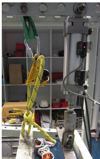
(Testi ponavljajočih obremenitev z maso 100 kg)
